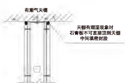
② 标准隔墙系统与有潮气天棚连接
